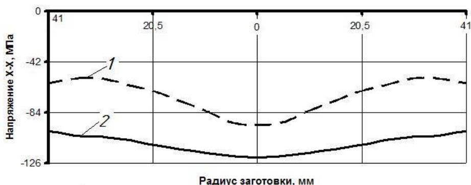
Рис. 4. Изменение напряжений ( $\sigma_{xx}$ ) в поперечном сечении заготовки (1 – обратное выдавливание с активным действием сил трения; 2 – обратное выдавливание)
