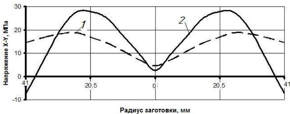
Рис. 8. Изменение касательных напряжений ( $\tau_{xy}$ ) в поперечном сечении заготовки (1 – обратное выдавливание с активным действием сил трения; 2 – обратное выдавливание)
