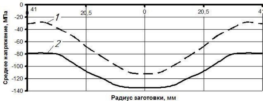
Рис. 7. Изменение средних напряжений ( $\sigma_{cp}$ ) в поперечном сечении заготовки (1 – обратное выдавливание с активным действием сил трения; 2 – обратное выдавливание)
