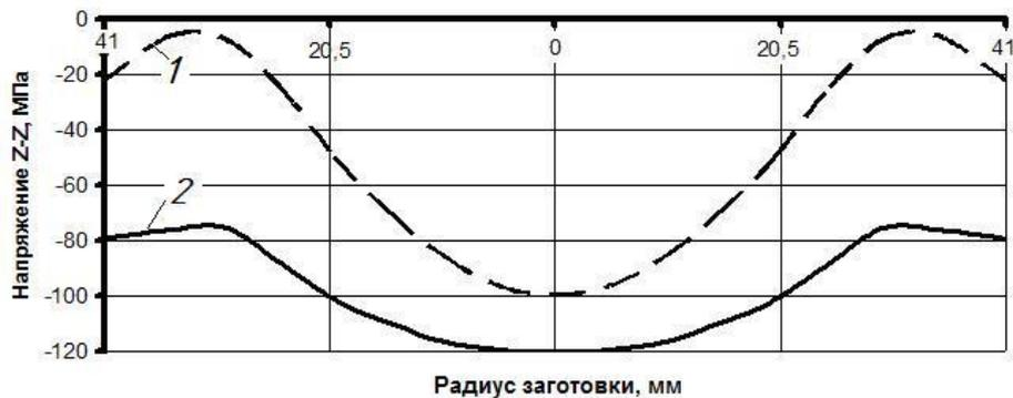
Рис. 6. Изменение напряжений ( $\sigma_{zz}$ ) в поперечном сечении заготовки (1 – обратное выдавливание с активным действием сил трения; 2 – обратное выдавливание)
