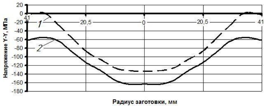
Рис. 5. Изменение напряжений ( $\sigma_{yy}$ ) в поперечном сечении заготовки (1 – обратное выдавливание с активным действием сил трения; 2 – обратное выдавливание)
